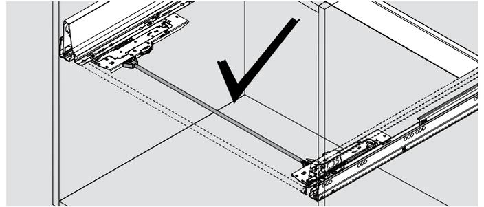
最適な機能を発揮し、TIP-ON BLUMOTION の作動反応エリアを最適化するために、シンク口機構連結棒を取り付けます。
