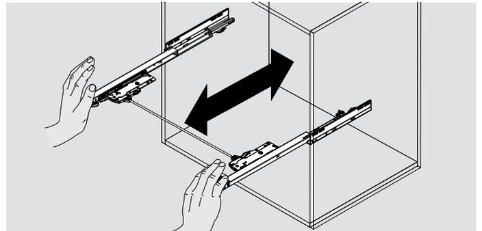
LEGRABOX / MOVENTO の場合: 受レールにシンク口機構を取り付けた状態で、平行に動かして開くか、または閉じます。これによってシンク口機構アダプターの損傷を防ぐことができます。
